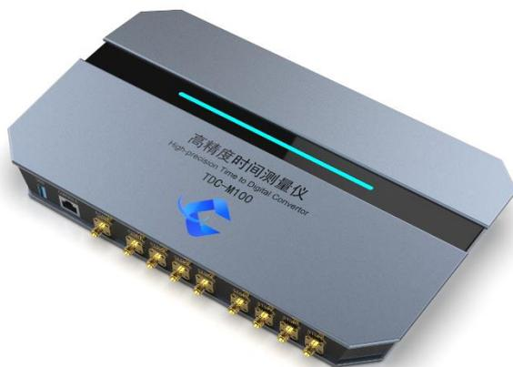
该产品可实现快速时间测量，工作在“启动-停止”模式下，启动信号作为时间测量起点，停止信号作为时间测量终点。适用于激光雷达、荧光寿命检测等有效事件到达时间不确定的应用；配合专用控制软件能够实现多种参数灵活配置和时间计数分布数据实时输出，有力支撑用户的各种应用需求，是一款高性能、低成本的时间测量仪器。
